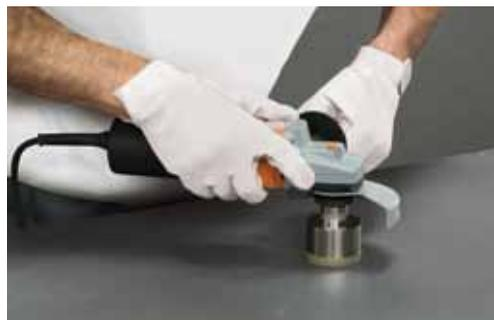
Per ottenere fori di diametro superiore agli **8-10 mm**, utilizzare frese a tazza diamantate, montate su trapani o su flessibile. Iniziare la foratura mantenendo l'utensile inclinato rispetto alla lastra. Questi strumenti possono essere impiegati a secco o ad acqua.
