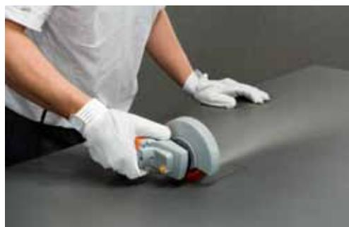
Per realizzare aperture interne alla lastra o tagli a L, utilizzare smerigliatrici elettriche con dischi diamantati a fascia continua, procedendo con elevate velocità di rotazione e basse velocità di avanzamento.
