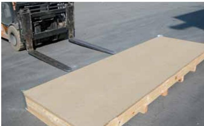
Per sollevare e spostare i vassoi di lastre **1000x3000 mm**, utilizzando carrelli elevatori o gru di cantiere, è importante inforcare l'imballo nel lato lungo, avendo cura di posizionarsi al centro dello stesso, allargando al massimo le forche che dovranno fare presa su tutta la profondità del pallet.
