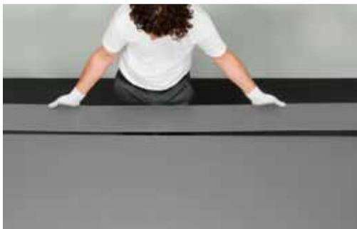
Per tagli sul lato lungo di Laminam **1000x3000 mm** posizionare la lastra su un piano stabile e planare, fissare sulla superficie da incidere una comune staggia di alluminio. Procedere al taglio e agli spacchi come descritto nelle figure 17, 18, 19. Afferrare la lastra a braccia aperte per il lato lungo e partendo dai bordi già aperti, esercitare una leggera pressione verso il basso fino ad ultimare lo spacco.
