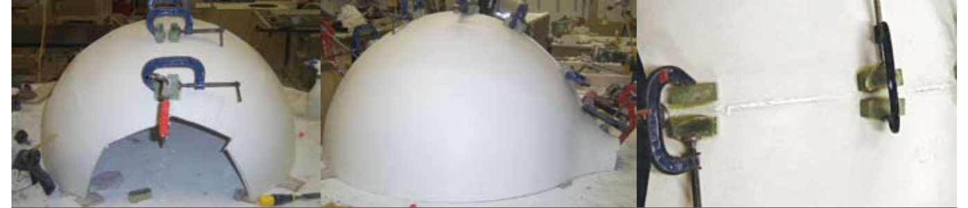
Assemblaggio di 2 quarti per formare metà della conchiglia
