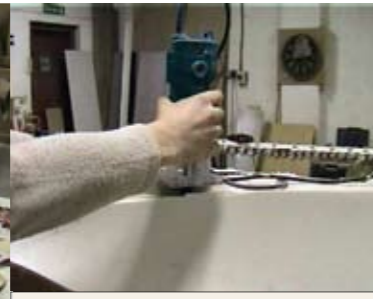
Preparazione della giunzione mediante rifilatura
