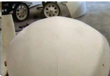
La giunzione del quarto di conchiglia è finita e pronta per essere levigata
