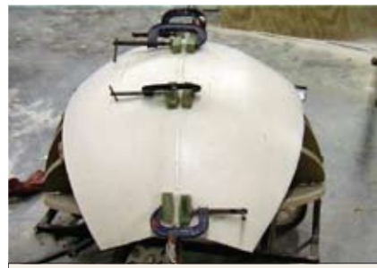
Giunzione di 2 segmenti per formare un quarto della conchiglia
